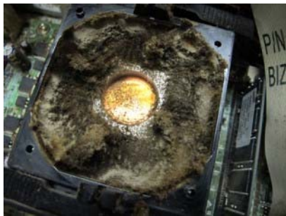
15 Nicotine aanslag op de koelribben voor de Processor. Koeler is gedemonteerd.
