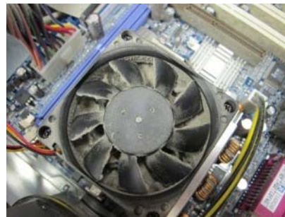
16 Stof op de koeler van Processor.
