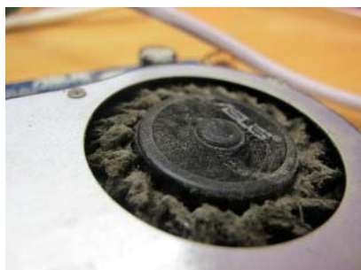
21 Laptop CPU Koeler. Nicotine en stof de grootste vijand van iedere Laptop.
